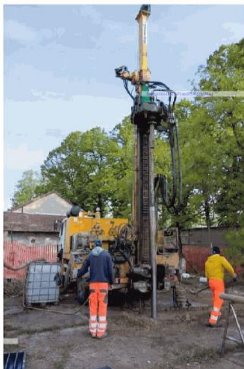
A sinistra le operazioni di prelievo di campioni da analizzare su suolo e acqua della ex Necchi (sopra) dopo i primi sopralluoghi (sotto)
