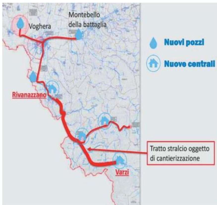
Lo schema complessivo di intervento per la realizzazione della nuova rete acquedottistica
